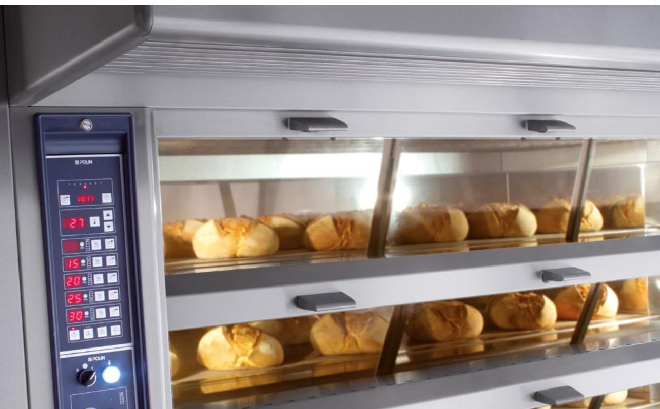
Confirman la eficiencia del sistema de calor de los Tubos de Vapor Polin, las mediciones efectuadas sobre la temperatura de los humos de combustión durante su expulsión, los cuales son solo pocos grados superiores a los de la cámara durante todo el proceso de cocción.
